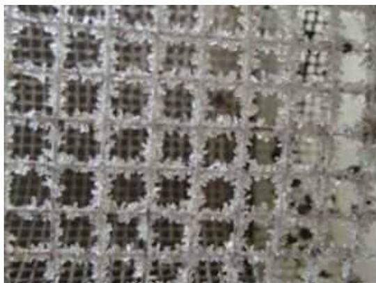
写真5 回収したリン結晶化物
