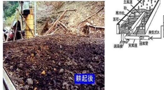
図22 脱臭装置の例(土壌脱臭装置)
