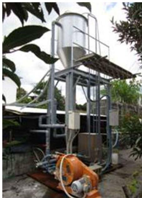
写真2 MAP反応槽(有効容積0.7m<sup>3</sup>)
