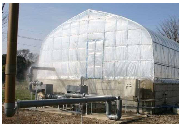
写真2 群馬県畜産試験場が開発した軽石脱臭装置
