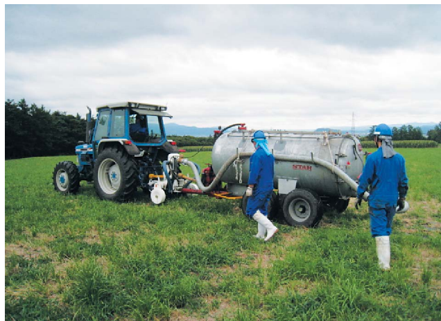
サブソイラー機能付きスラリーインジェクター(トラクターとバキュームタンク間に接続し、悪臭の発生を抑制しながら心土破碎と液肥注入(25cm深)を同時に行います。)
