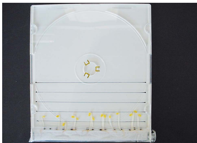
CDケースを利用したコマツナの発芽試験 (堆肥の簡易品質評価法として実施します。)
