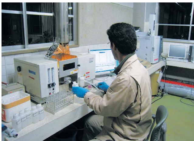
原子吸光分析法による土壌溶液中の環境負荷物質(重金属類)の測定(Cu、Zn等の動態をチェックしています。)
