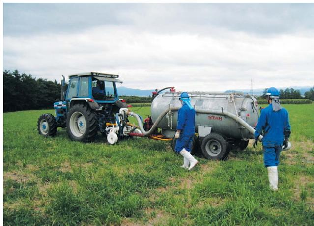
サブソイラー機能付きスラリーインジェクター(トラクターとバキュームタンク間に接続し、悪臭の発生を抑制しながら心土破碎と液肥注入(25cm深)を同時に行います。)
