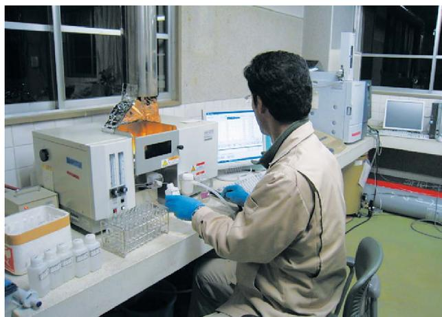
原子吸光分析法による土壌溶液中の環境負荷物質(重金属類)の測定(Cu、Zn等の動態をチェックしています。)
