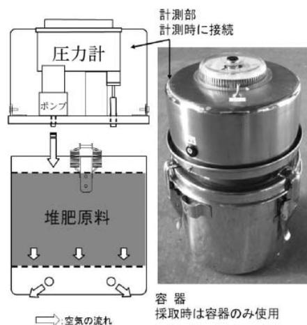
図4 測定装置とその概要
