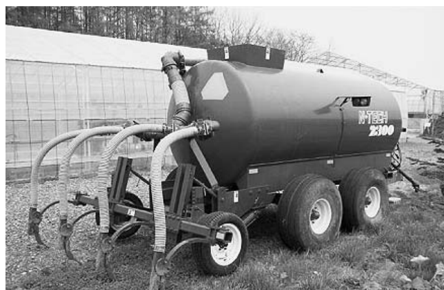
写真1 かん注施用に用いたスラリータンクプレッダーと付属のフローティングインジェクター
