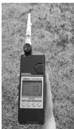
写真1 畜環研式ニオイセンサの外観と測定イメージ
