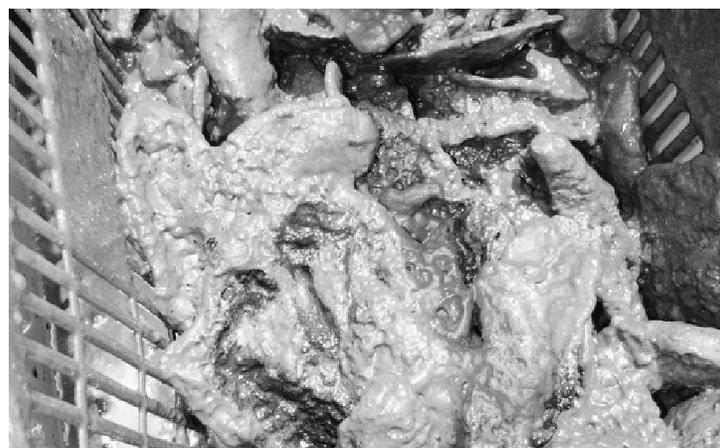
写真2 消化槽に充填したカキ殻付着汚泥
