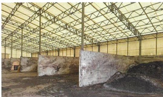
写真3 2次発酵槽(堆積高さ3m、強制通気式)
