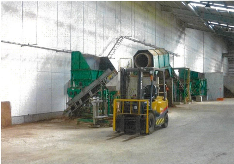
写真8 製品堆肥の篩分け機(中央)と袋詰め装置(左)
