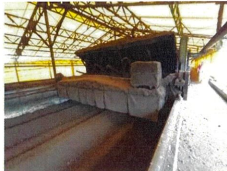
写真5 一般堆肥の二次発酵槽(左)、攪拌ロータリー(右)
