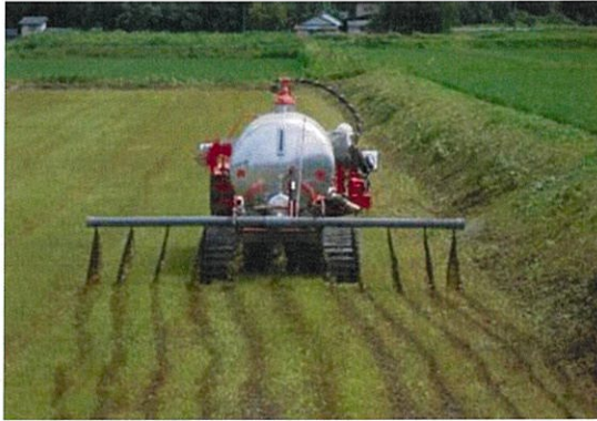
写真 12 自走式バキュームタンクでの散布
