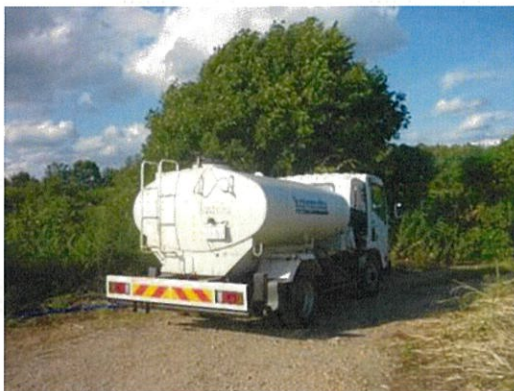
写真10 タンク容量4tのバキュームカー
