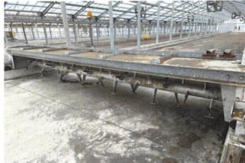
写真4 乾燥ハウス(堆積高さ0.3m、6m幅、4レーン)
