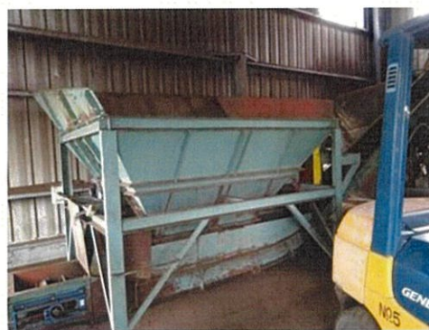
写真9 袋詰め作業機の全体(左)、原料ホッパー(右)
