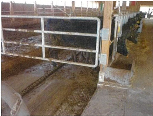
写真2 スクレーパーによる肉牛舎のふん尿収集
