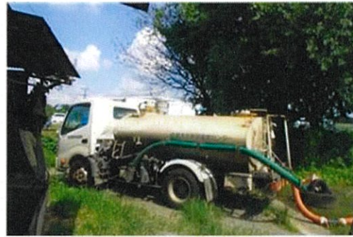
写真 12 スラリーを収集するバキュームカー
