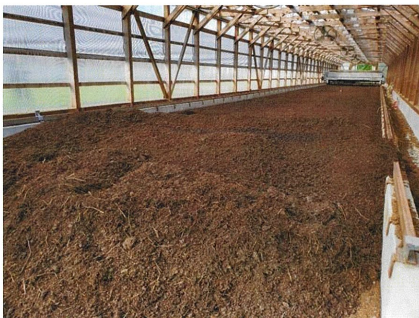
写真5 戻し堆肥の水分を下げる堆肥化施設
