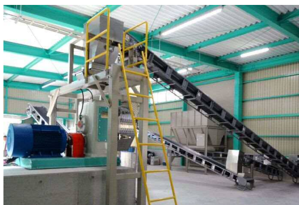
写真 養鶏農家による堆肥ペレット化装置の整備 (H27度畜産環境整備機構のリース事業を活用)
