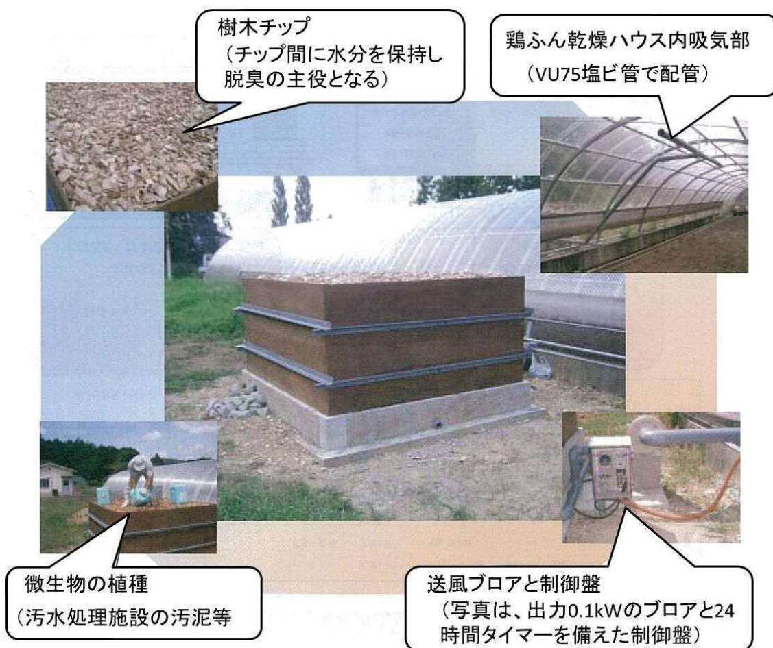
図1 樹木チップを用いた低コストアンモニア脱臭装置 (京都府ホームページ 環境対策技術 3 臭気対策)
