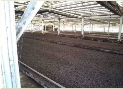
写真2 ロータリー攪拌式発酵舎
