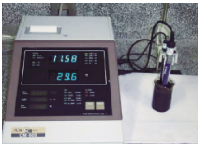
ECメーターによる牛尿の肥料成分測定
