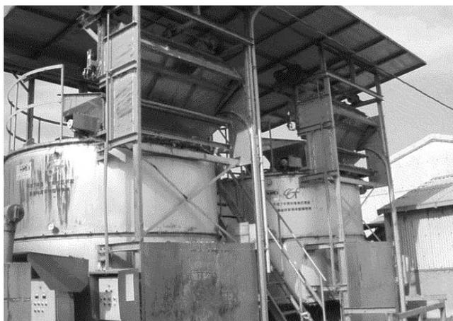
図3 高成分堆肥製造方法（密閉縦型発酵装置）
